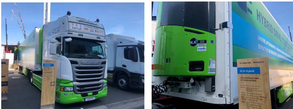
Kunden-Referenzfahrzeug auf der IAA: Sattelzug von MJ Transport GmbH mit der SLXi Hybrid Kühlmaschine – die Hybrid-Variante hat einen Diesel-/Elektro-Kombiantrieb an Bord
